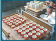
Technologien wird jetzt mit isostatischen Trockenpressen Flachgeschirr aus Porzellanpulver trockengepresst. Im so genannten Spritzgießverfahren wird – ähnlich wie bei der plastischen Kunststoffverformung – flüssige
