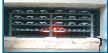
Grad in einem Dekorbrandofen gebrannt. Hierbei verbinden sich die Farben mit der Glasur. Eine Erfindung der Porzellanmanufaktur Kahla ist die patentierte „Touch“-Oberfläche. Die sich samtartige anfühlende „Haut“ ist sogar spülmaschinenfest. Im für jedermann geöffneten Werksverkauf wurde noch das eine oder andere Stück erstanden.
